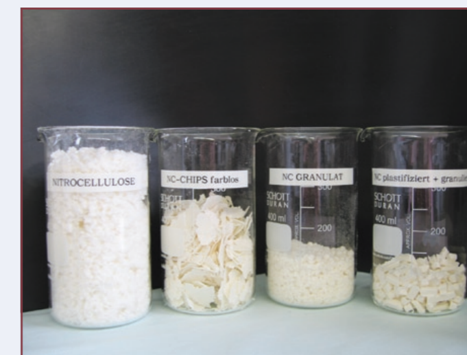
Volumenunterschiede bei gleicher Produktmenge (jeweils 50g) für die unterschiedlichen Lieferformen von Nitrocellulose
